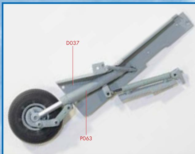
**8** Ось собранной опоры шасси вставьте в пазы, находящиеся на стенке и крышке ниши правой основной опоры шасси (D037), как показано на снимке.
