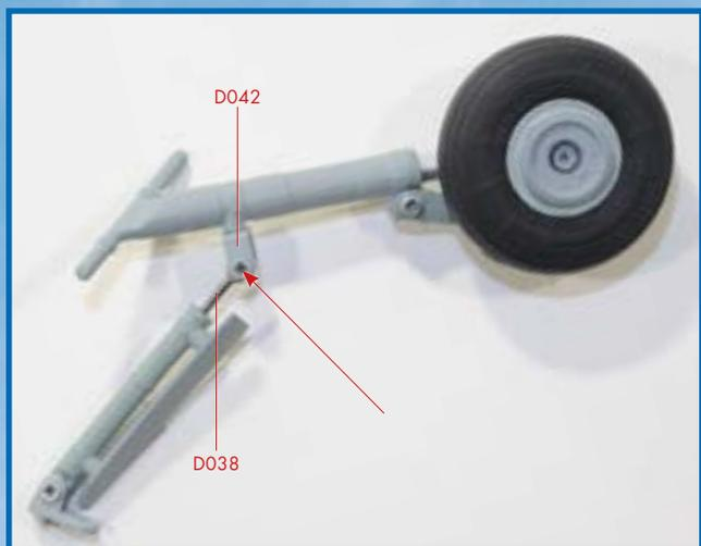
**7** Вставьте проушину штока гидроцилиндра-подъемника (D038) в вилку (D042) и закрепите ее винтом JM.
