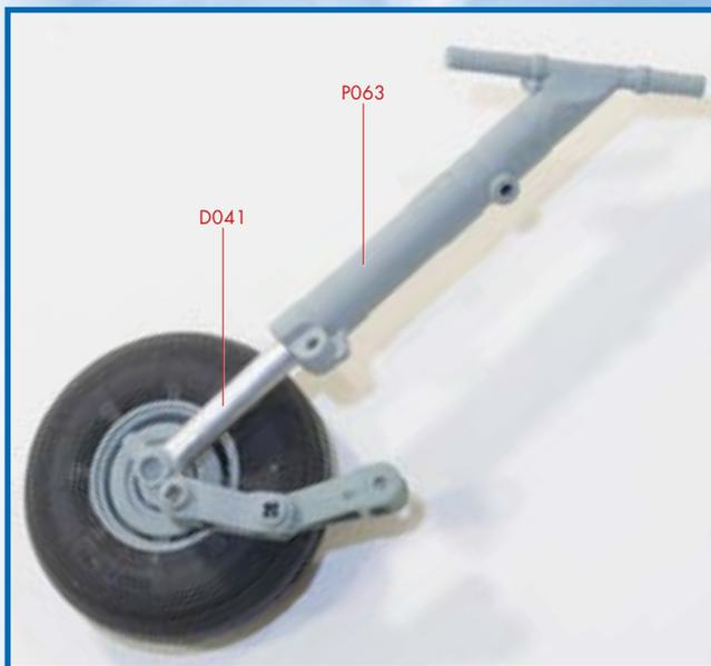
**4** Затем за пружиной (X002) вставьте шток амортизатора колеса (D041) в полость стойки правой основной опоры шасси (P063), как показано на снимке.
